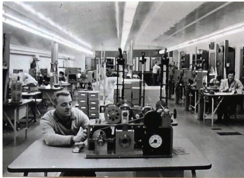
Styrautomatverkstaden för underhåll av gyro och servo 1964
