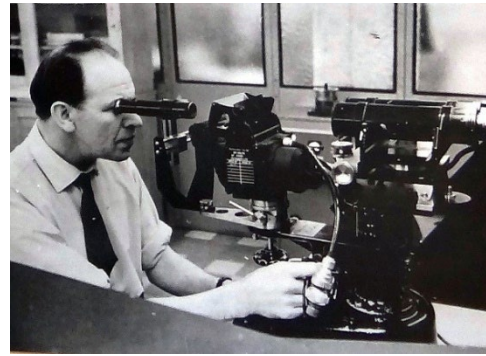
Kontrollmätning av reflexsikte 1964
