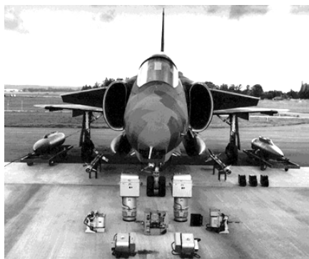
SF 37 med kameror och mörkerspaningskapslar och i aktion bestyckad med "Podar"
