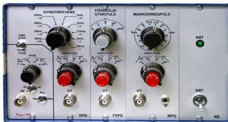
Kalibreringsgenerator KPG 7. Frontpanel med 4 st. PLUG-IN enheter
