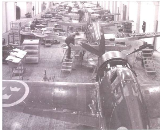
Montering av J 22 i P-tunnelen
