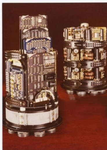
Navigationssystem FLI-35 (AMPE-35 och förstärkare E1)
