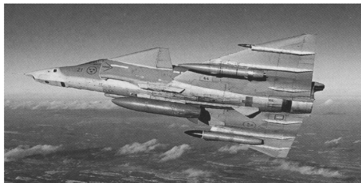
SF 37 med kameror och mörkerspaningskapslar och i aktion bestyckad med "Podar"
