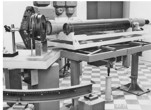
Mätning av objektiva med kolimatorutrustning Tu 1 nedre 1953
