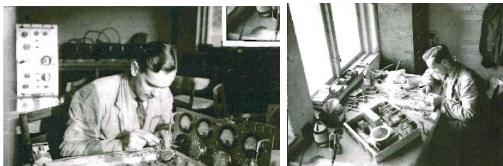
Bernt "Macke" Edin gör översyn vid Bunge flygplats på t.v. Fmr-IV manöverenhet och t.h. kodgivare för tal fyr.
