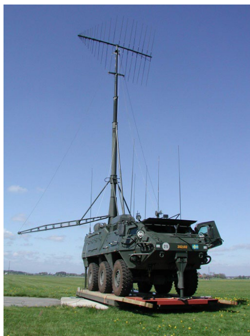
PASI XA202 med störutrustning mot radioförband.
