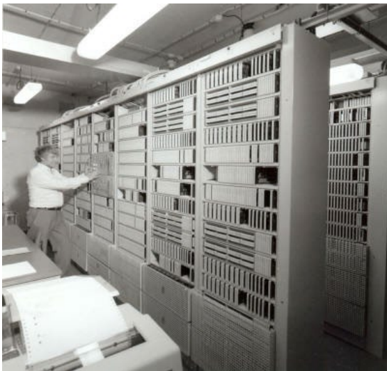
Telefonväxel AKE-129. Åtta stativ utgör två parallellarbetande datorer
