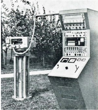
Stötprovmaskin och registreringsutrustning för Zonrör Rb 68. Rb 68, Bloodhound MK II
